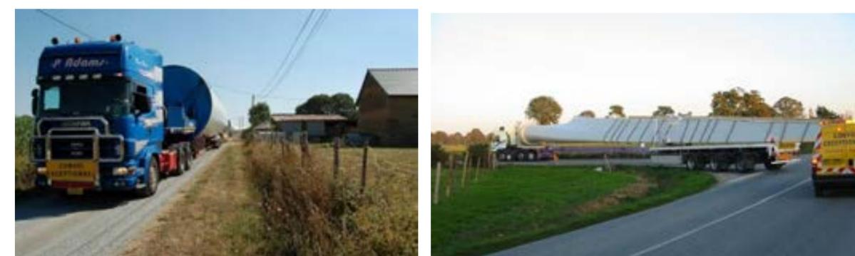
Photo 140 : Le transport des éléments d'une éolienne
